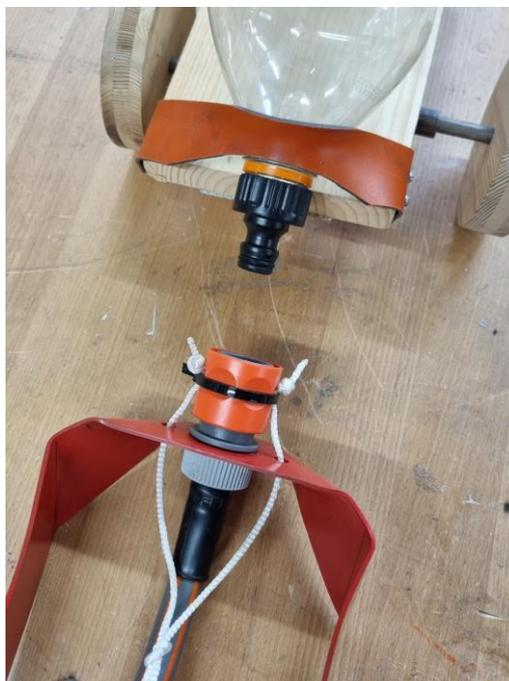
Das Zugseil ist lediglich mit einem Kabelbinder am Entriegelungsring der Kupplung befestigt.
