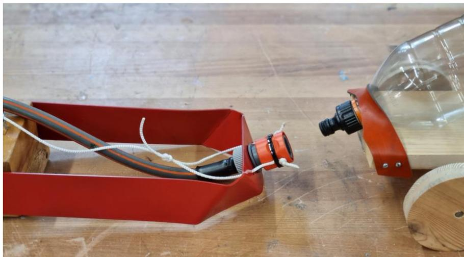
In diesem Beispiel wurde der Bügel aus einem Blechstreifen (2mm/50mm) gefertigt. Natürlich kann der Abgang auch ohne eine entsprechende Apparatur ausgelöst werden. Da die Kupplung sich allein durch Zug auf den orangenen Ring löst, wird das Fahrzeug während eines manuellen Starts nicht beeinträchtigt.
