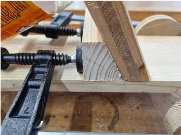
Links: Um stumpfe Leimstellen zu verstärken, eignen sich in Form gebrachte Leisten. Den besten Halt bietet eine Verschraubung. Gute Stabilisierung bietet auch eine saubere Verleimung.
