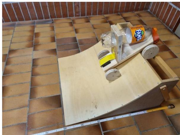
Als Rampe eignet sich jede schiefe Ebene. Günstiger ist ein Modell, bei dem der Start bewusst und für alle gleich ausgelöst werden kann. Ob die Rampe ein lineares oder ein gebogenes Gefälle besitzt, spielt für den Versuch ebenfalls keine Rolle. Eine dünnere Platte lässt zum einen eine Biegung zu und zum anderen ist die Stufe auf die Fahrbahn weniger hoch. Wichtig ist, dass alle Fahrzeuge von der gleichen Rampe fahren.
