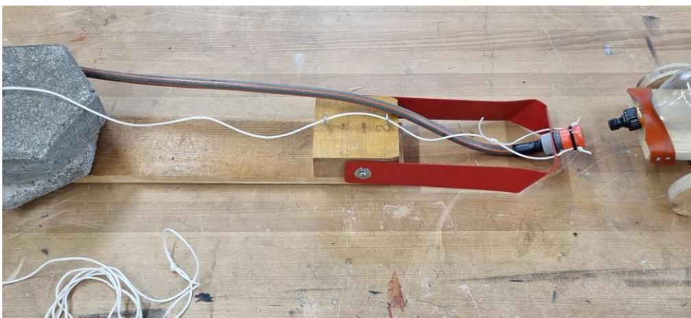
Die Kupplung ist an einem beweglichen Bügel (rot) befestigt, da durch die unterschiedlichen Bauweisen die Flaschendeckel nicht alle auf gleicher Höhe sein werden. Die Steine links im Bild dienen der Beschwerung.
