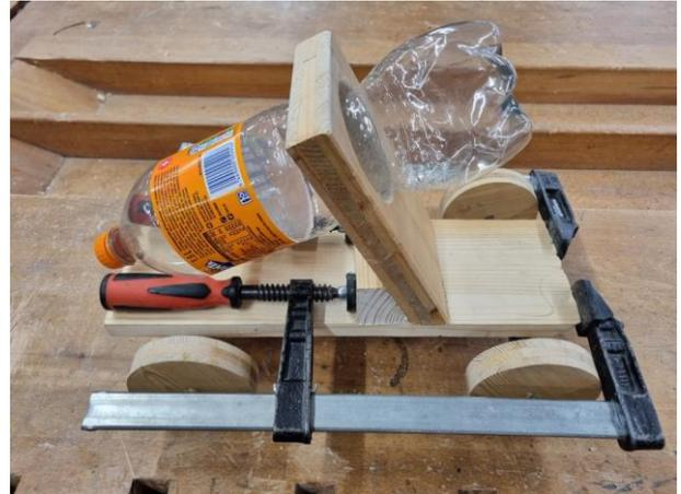
Rechts: Ansicht eines Aufbaus. Die Flasche ist hinten noch nicht gesichert. Die Spanne zwischen den Achsen ist bei diesem Modell klein. Beim Antrieb mit Druckluft besteht die Gefahr zu kippen.
