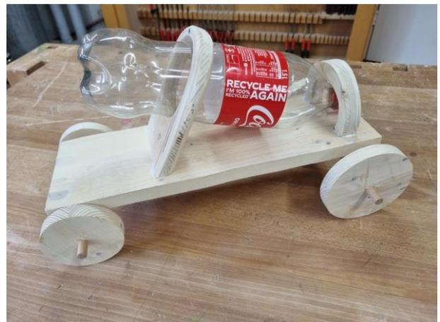
Rechts: Diese Befestigung besteht aus Holz. Die Achsen sind in Ringschrauben geführte Dübelstäbe. Holz reagiert auf Feuchtigkeit und dies erhöht die Reibung. Die Flasche kann durch den Holzring am Hals nicht genügend eingeklemmt werden. Wie sich das auf das Fahrverhalten auswirkt, wird sich zeigen.
