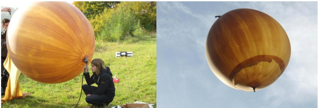
*Im linken Bild sieht man links, wie die Lastverteilungshaut abgetrennt wird. Nachher sieht der Ballon so aus, wie im rechten Bild zu sehen. Das Füllventil ist dabei oben, am unteren Ende kann dann die Last angehängt werden.*
