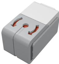
Der Gyrosensor misst die Drehgeschwindigkeit. Er kann also messen, wie schnell sich ein Roboter um die eigene Achse dreht. Dies kann er nur um eine Achse, nämlich um diejenige, die von oben nach unten durch den roten Punkt des Sensors geht. Aus der Drehgeschwindigkeit kann auch der Drehwinkel berechnet werden. Damit dies möglichst exakt erfolgen kann, darf die Drehgeschwindigkeitsmessung keinen Fehler des Nullpunkts haben. Das heisst, der
