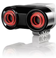
Mit dem Ultraschallsensor kann der Roboter Entfernungen zu bestimmten Objekten oder zur Wand messen. Er besteht aus einem Sender im linken Auge und einem Empfänger im rechten Auge. Das Prinzip ist dasselbe wie bei einer Fledermaus, die durch die Nacht fliegt. Der Sender sendet ein Ultraschallsignal aus, das auf einen Gegenstand oder eine Wand trifft und dabei reflektiert wird. Der
