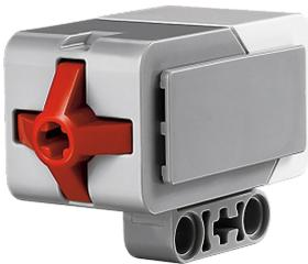
Der Roboter „fühlt“. Der Kontaktschalter besitzt vorne ein rotes bewegliches Köpfchen, das hineingedrückt werden kann. Fährt der Roboter mit diesem Sensor gegen eine Wand oder einen anderen Gegenstand, wird das Köpfchen eingedrückt und der Roboter merkt, dass etwas im Weg ist.
