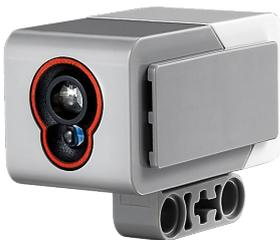
Der Roboter „sieht“. Der Lichtsensor misst die RGB-Farben oder umgerechnet auch die Lichtstärke (Helligkeit) in seiner Umgebung. Auf der Front sieht man zwei kleine Linsen. Die obere ist der Sensor, welcher die RGB-Farben misst und die untere ist ein LED (also quasi eine kleine Taschenlampe). Der Sensor kann in 3 verschiedenen Varianten gebraucht werden: 1. Messung der Lichtstärke, die in den Sensor fällt, ohne eigene Beleuchtung, als nur Umgebungslicht. 2.
